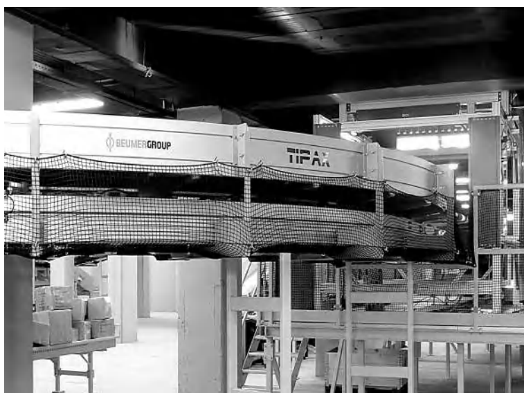
کانوایر با ظرفیت سورت ۷ هزار بسته در ساعت
